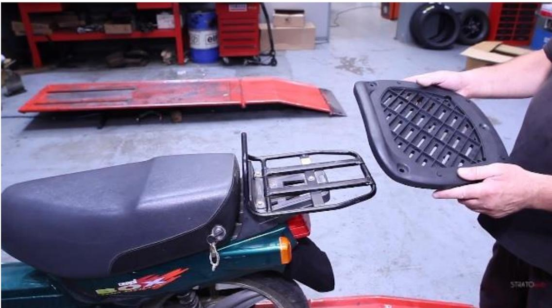
Debemos de colocarlas de forma que queden bien encajadas en alguno de los tubos y sujetas con sus tornillos para fijar el soporte.
