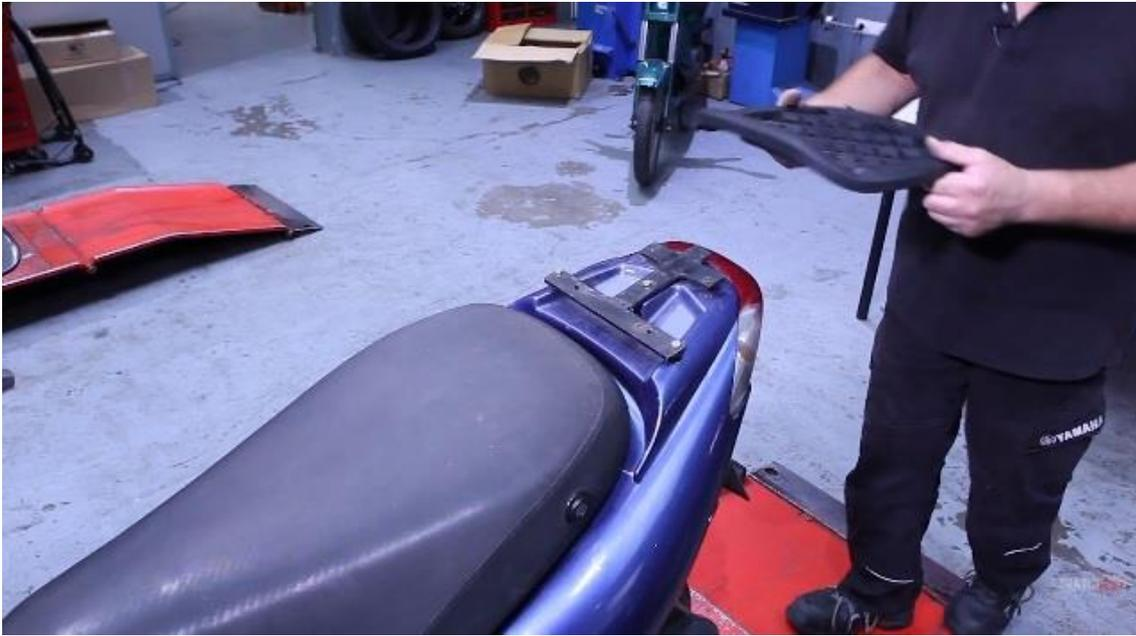
En este caso es suficiente con colocar la base y atornillarla al soporte metálico.
